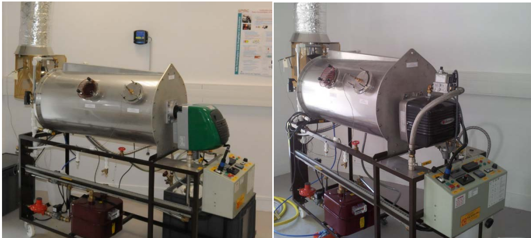
Figure 4: Chambre de combustion (chaudière) avec le bruleur liquide et le bruleur gazeux
